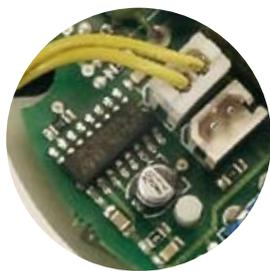
Versione HT con circuito elettronico a microprocessore
