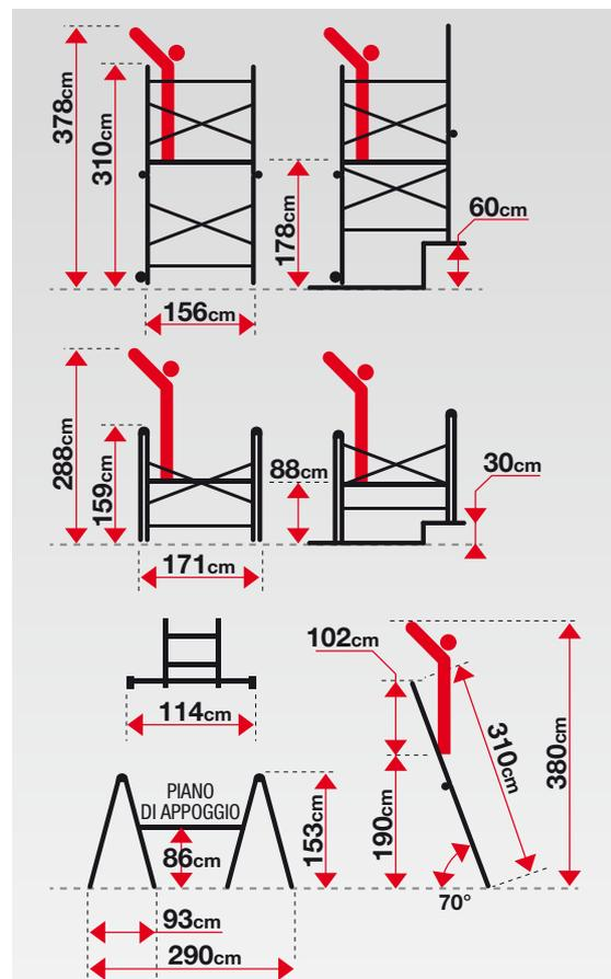
**ATTENZIONE!** barre stabilizzatrici a doppia posizione per lavorare a muro
