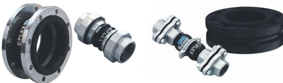
Per resistere alle sollecitazioni dovute alla pressione ed alla temperatura a cui saranno sottoposti in esercizio, i giunti in gomma sono rinforzati internamente da più strati di fibre tessili e da fili d'acciaio opportunamente disposti. In tal modo il giunto in gomma può essere tranquillamente utilizzato nelle tubazioni al fine di:
